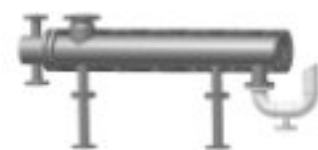
Rohrbündelwärmetauscher - Dampfbeheizt/L HDD/NDD - KOND - PWW
